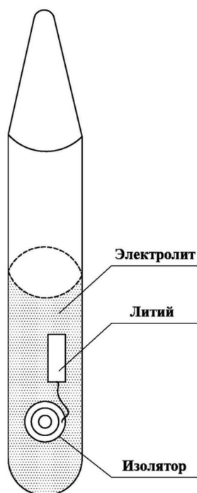
Рис. 4. Конфигурация стеклянной ампулы для моделирования среды ХИТ
