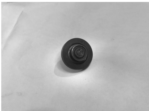
Рис. 1. Изолятор элемента ИСП3-1 для источника тока ФУЛ-600
