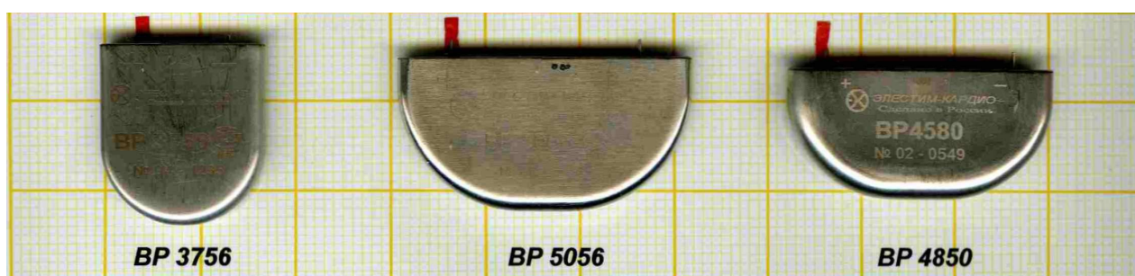
Рис. 7. Образцы литий-фторуглеродных источников тока для ЭКС производства НПО «Медисток»
