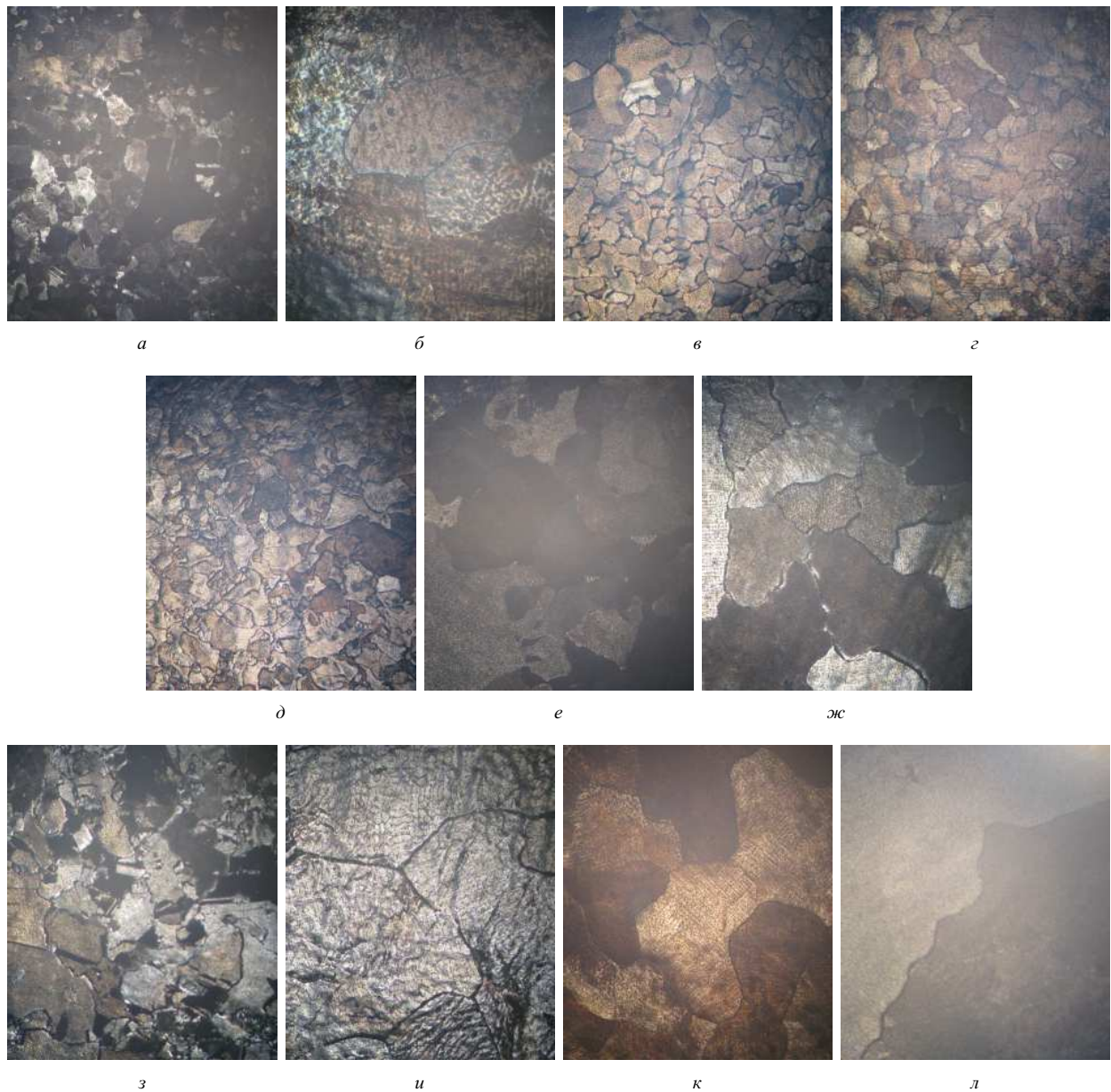
Рис. 7. Микроструктура свинцово-оловянных и свинцово-оловянно-кальциевых сплавов: а – Pb, б – (Pb – 1.0 мас. % Sn); в – (Pb – 1.5 мас. % Sn); г – (Pb – 2.0 мас. % Sn); д – (Pb – 3.0 мас. % Sn); е – (Pb – 1.25 мас. % Sn – 0.01 мас. % Ca – 0.015 мас. % Al); ж – (Pb – 1.0 мас. % Sn – 0.04 мас. % Ca – 0.015 мас. % Al); з – (Pb – 1.0 мас. % Sn – 0.06 мас. % Ca – 0.015 мас. % Al); и – (Pb – 1.0 мас. % Sn – 0.08 мас. % Ca – 0.015 мас. % Al); к – (Pb – 1.0 мас. % Sn – 0.06 мас. % Ca – 0.015 мас. % Ba); л – (Pb – 1.0 мас. % Sn – 0.06 мас. % Ca – 0.023 мас. % Ag). Увеличение 40 х
