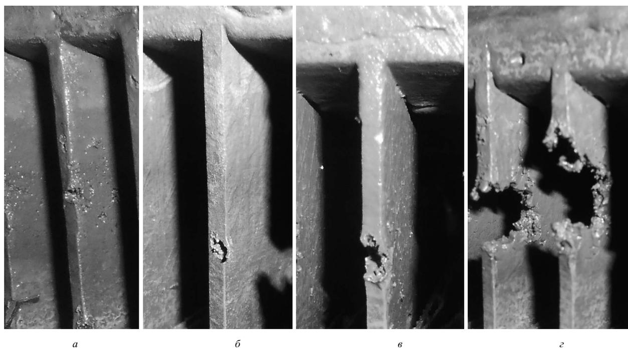
Рис. 5. Внешний вид дефектов на ушках отрицательных электродов свинцово-кислотных аккумуляторов большой ёмкости, демонстрирующий их развитие во времени, при работе системы перемешивания электролита
